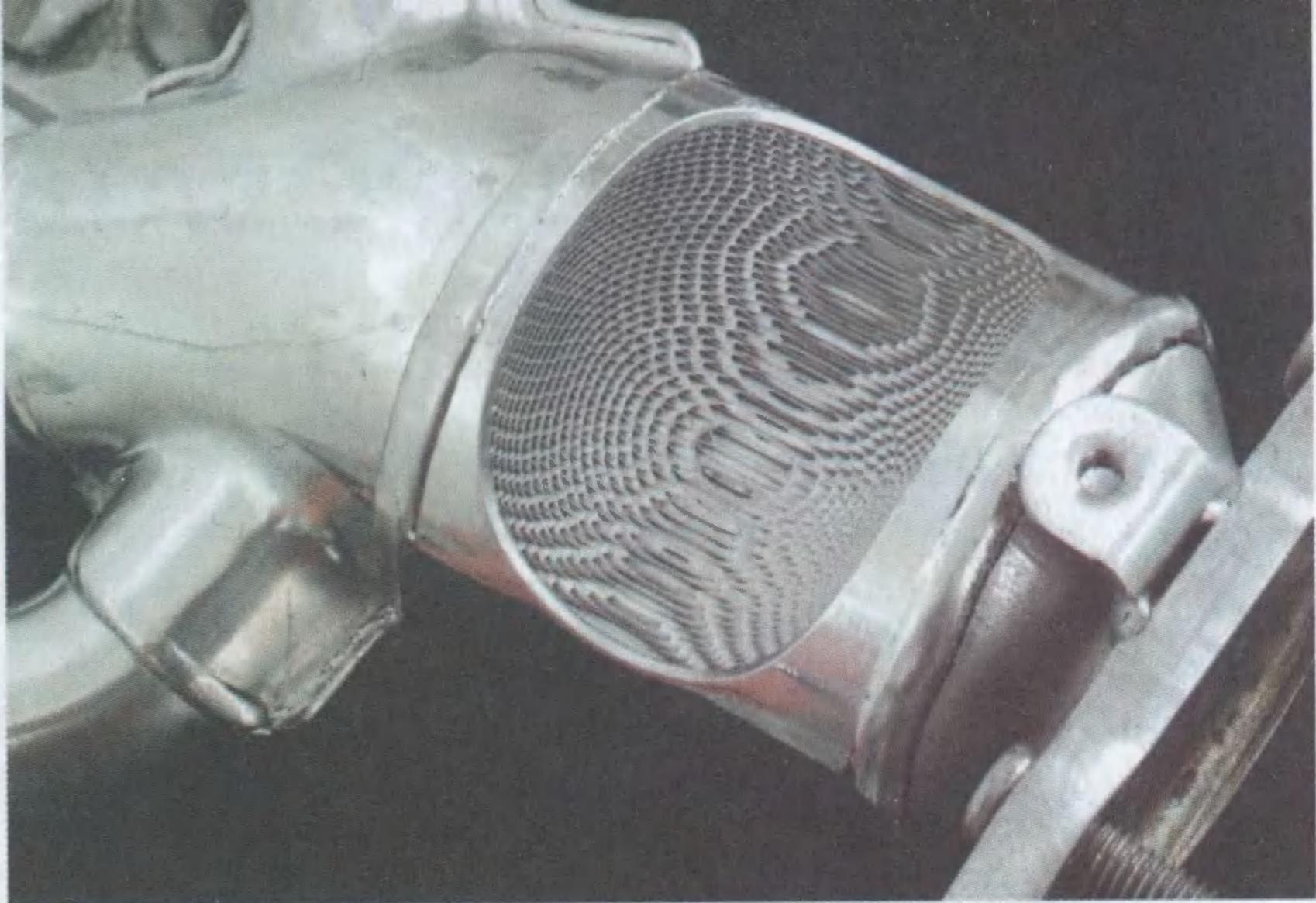
Катализатор в выхлопной трубе современного автомобиля.
