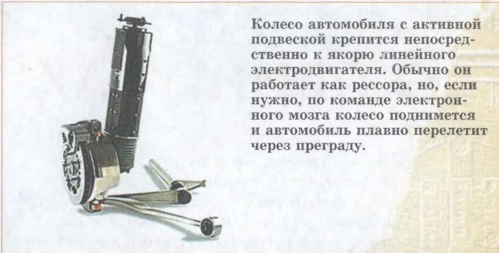
Колесо автомобиля с активной подвеской крепится непосредственно к якорю линейного электродвигателя. Обычно он работает как рессора, но, если нужно, по команде электронного мозга колесо поднимется и автомобиль плавно перелетит через преграду.
